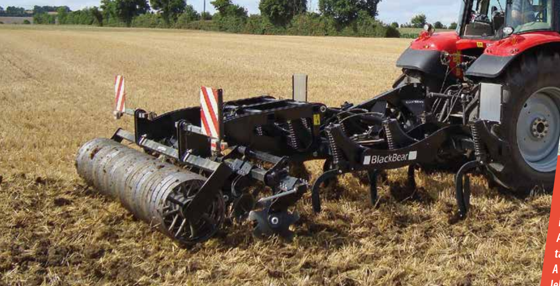
Szárnyas kések, talajkopírozó kerék (opció)
