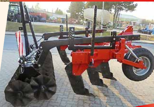
Ø 500 mm-es tandem hullámos tárcsa
