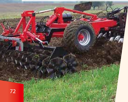
Kétsoros hullámos tárcsahenger, Ø550 mm
