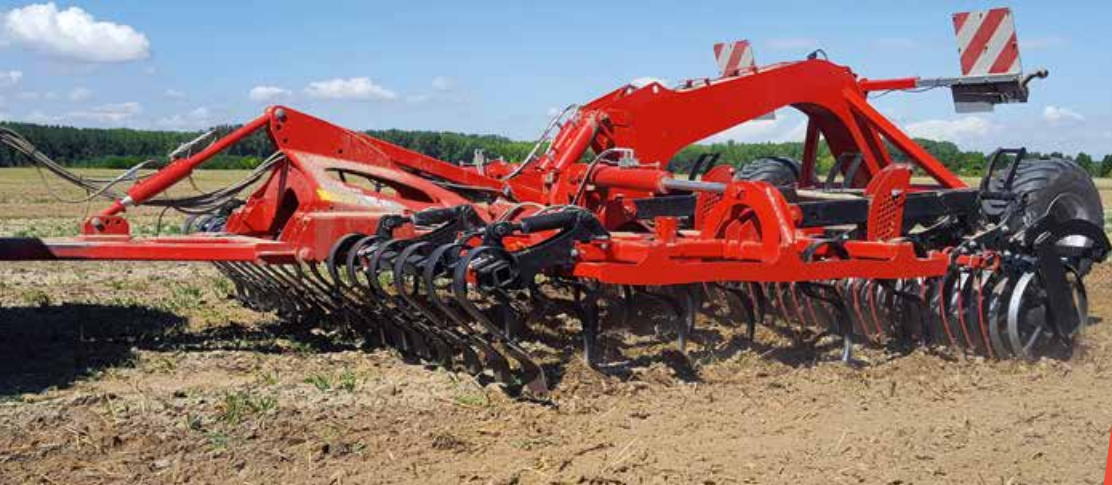
Szállítási helyzet Z-lezáró hengerral
