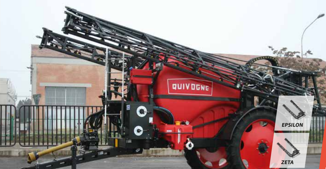
Paralelogramma szórókeret függesztés
